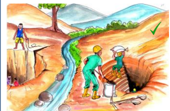
Leçon 12 : Il est recommandé à tout exploitant minier artisanal de porter un équipement de protection individuelle (botte, casque, cache-nez, bouche-oreille, gans, lunettes, salopette, ...).
