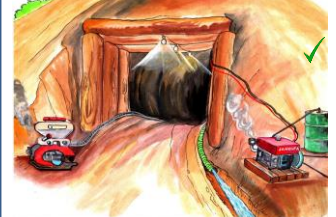
Leçon 14 : Les puits doivent être bien soutenus, avec en permanence un système d'éclairage-aérogage-exhausteur afin de réduire les risques d'accidents de travail. Il est recommandé d'utiliser pour l'éclairage des lampes à cathode froide (ampoules blanches).
